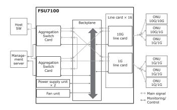
Fig. 1. Block Diagram
