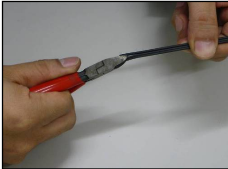
1 : Séparer le fil d'acier du câble à l'aide d'une pince coupante.
