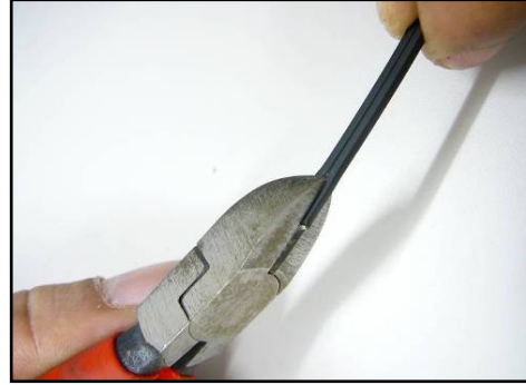
4 : Faire une fente le long de la rainure de la gaine du câble à l'aide d'une pince coupante.
