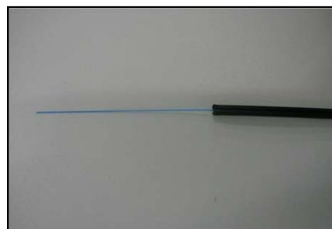
6) 光缆外皮去除完毕。另一侧的光缆也按 1~5 的步骤进行。请保持 2 根光缆去除涂覆层部分的长度一样。
