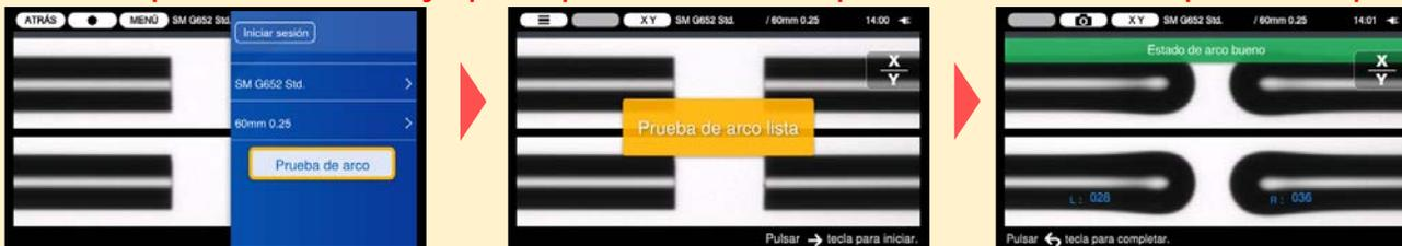
1. Mover el cursor "□" hacia "Prueba de arco" usando la tecla ▼ y pulsar la tecla F2.
