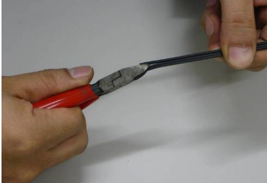
1. Separe el fiador con unos alicates.
