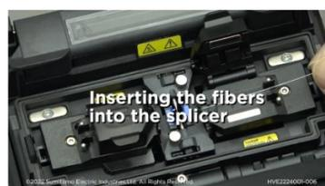
Inserção de fibras na máquina de fusão
