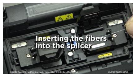
Insertion de la fibre dans la soudeuse
