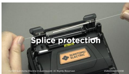
Protection de l'épissure
